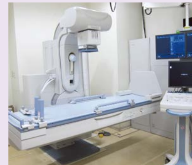
フラットパネル式のTV装置です。 内視鏡検査で活躍しています。
